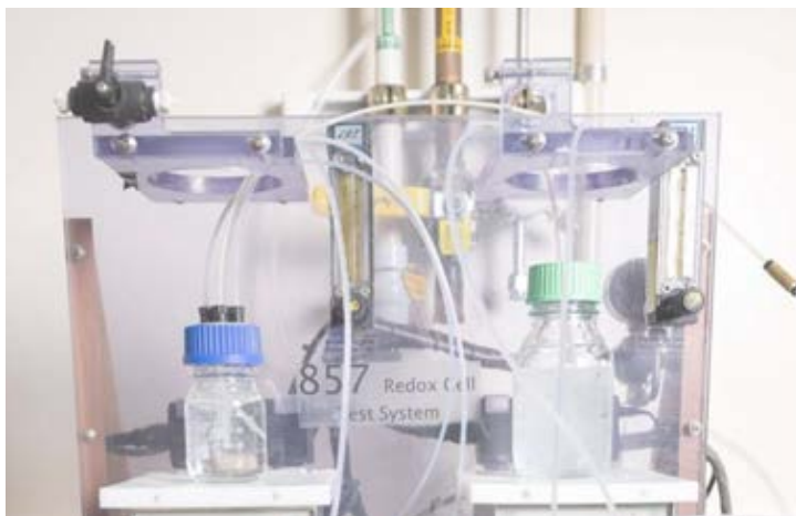
Il nuovo progetto di reattore elettrochimico che converte l'anidride carbonica estratta dall'aria tramite un processo più economico e semplice che richiede meno energia
